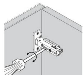
Unabhängige Höheneinstellung (Stellen Sie immer beide Scharniere ein, um Spannungen zu vermeiden)
